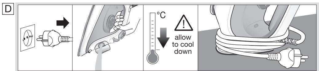
**EN** Descaling / **LT** Nukalkinimas / **LV** Atkaļkošana / **ET** Katlakivi eemaldamine
